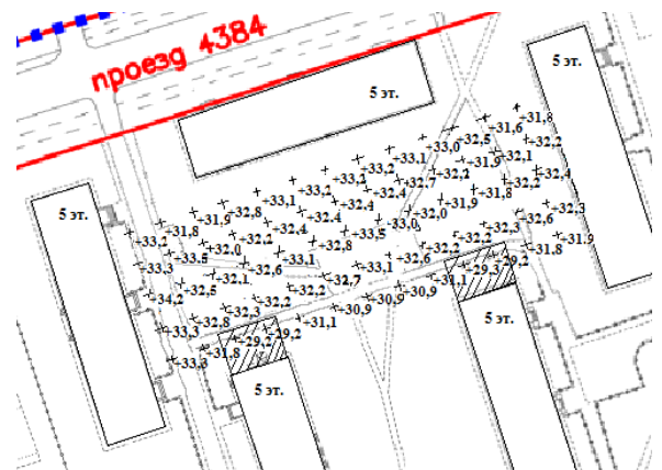
Рисунок 3.14. Пятиэтажный жилой фонд: а) Расчетное пространство двора; б) Радиационные температуры ( t_r ) двора
